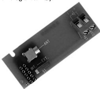
Benyttes ekstern antennen 66 99 408 afisoleres antennekablet, skærmen bøjes bagud over isoleringen og monteres i bøjlen for at sikre et godt stelplan for antennekablet. Afisolér underlederen og monter i skrueterminalen.
