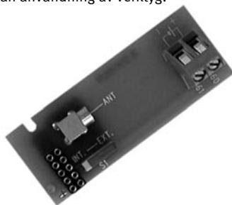
Används extern antenn 66 99 408 avskalias antennkabeln, skärmen böjs bakåt över isoleringen och monteras i kabelavlastningen för att säkra en god jordpunkt för antennkabeln. Skala av den inre ledaren och montera i skruvplinten.
