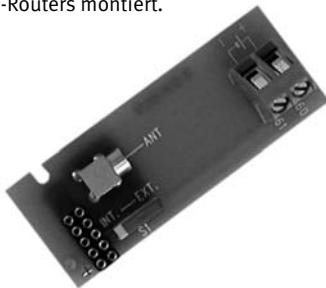
Wird externe Antenne Nr. 66 99 408 verwendet, soll die Antennenleitung abisoliert, den Schirm rückwärts über die Isolierung gebogen und in den Bügel montieren werden, um eine gute Masseebene für die Antennenleitung zu sichern. Den Innenleiter abisolieren und in die Anschlussklemme montieren.
