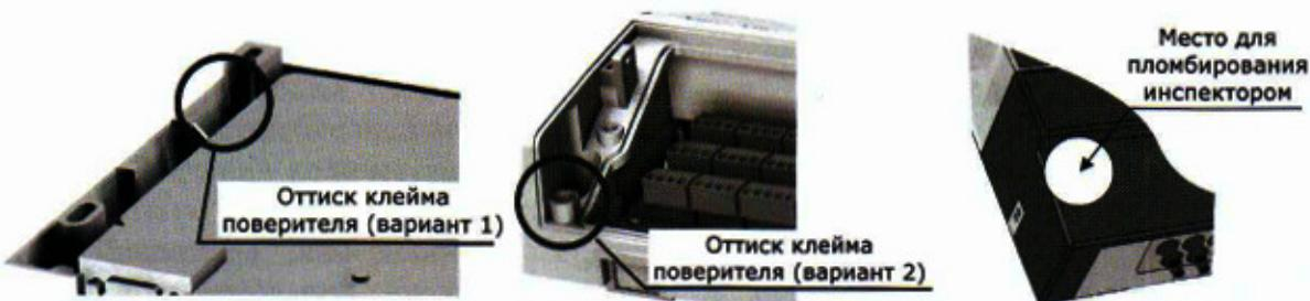
Рисунок 3 – Места пломбирования тепловычислителя
