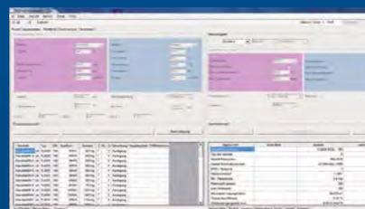
thermowave использует собственную программу подбора (thermoline Calculator). Вы гарантированно получите оптимальный аппарат, рассчитанный с учётом рабочего давления, гидравлики и термодинамики.
