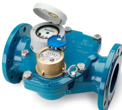
Комбинированный счётчик Турбо является особой конструкцией комбинированного счётчика для регистрации сильно колеблющихся расходов. В отличие от обычного комбинированного счётчика корпус счётчика при поверочной замене может оставаться в трубопроводной сети и заменяется только поверяемая измерительная вставка. Главный счётчик, дополнительный счётчик и переключающий вентиль смонтированы на одной панели. Поверочная замена может быть проведена просто, быстро и недорого.
